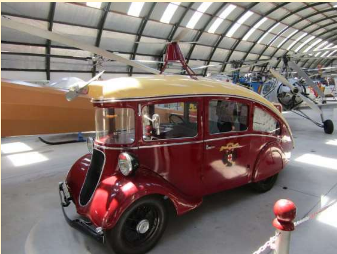
Furgoneta autogiro BCD de fabricación española sobre chasis de automóvil Singer, creada en 1935.
