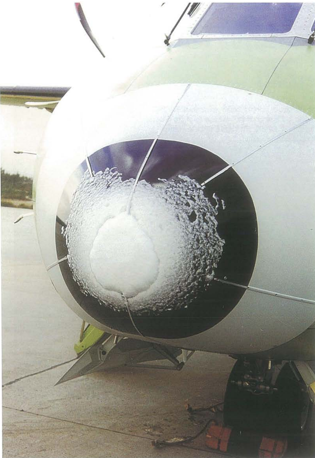
Acumulación en el morro del avión.
