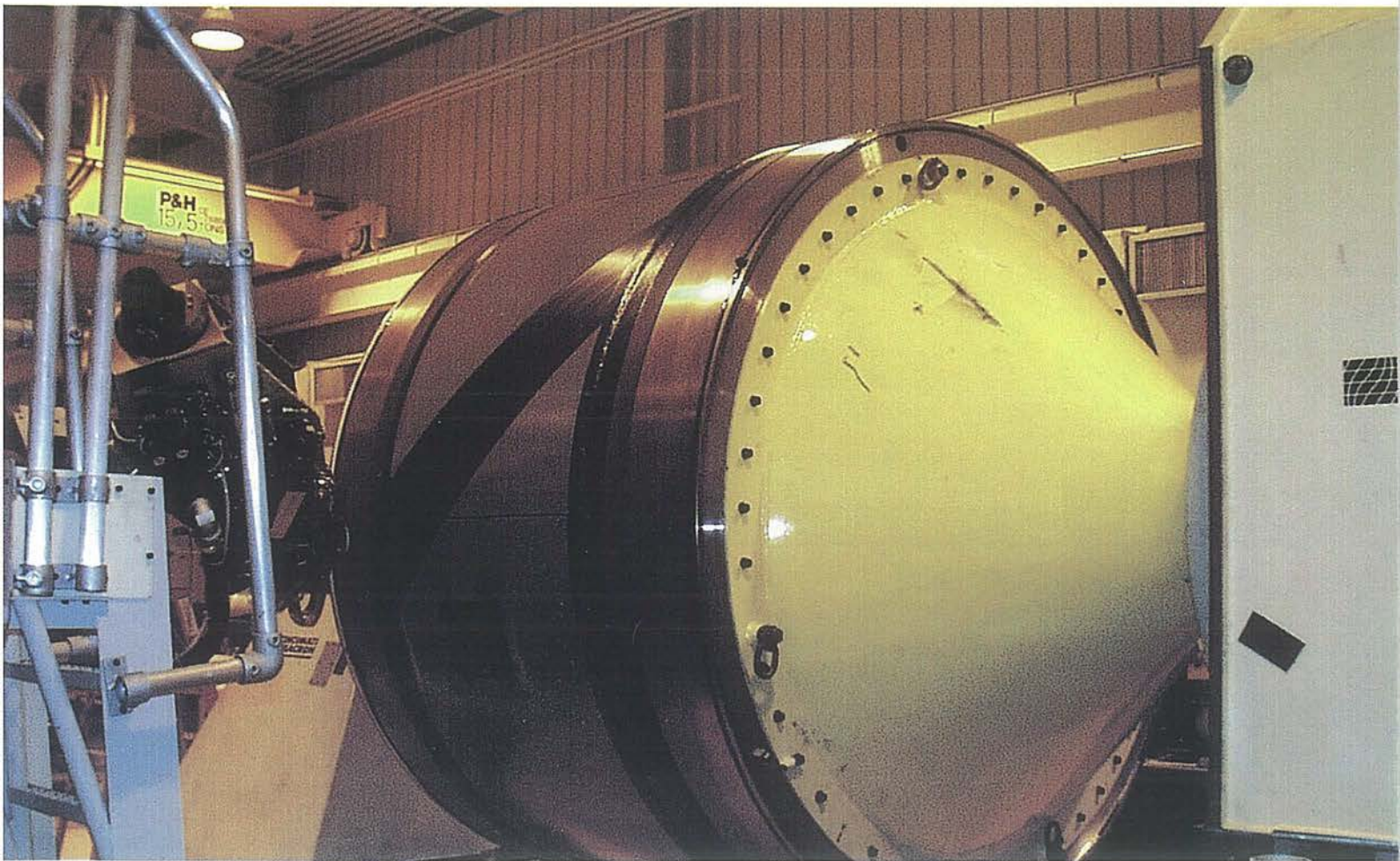
Detalle del cabezal depositando fibra de carbono sobre el útil.
