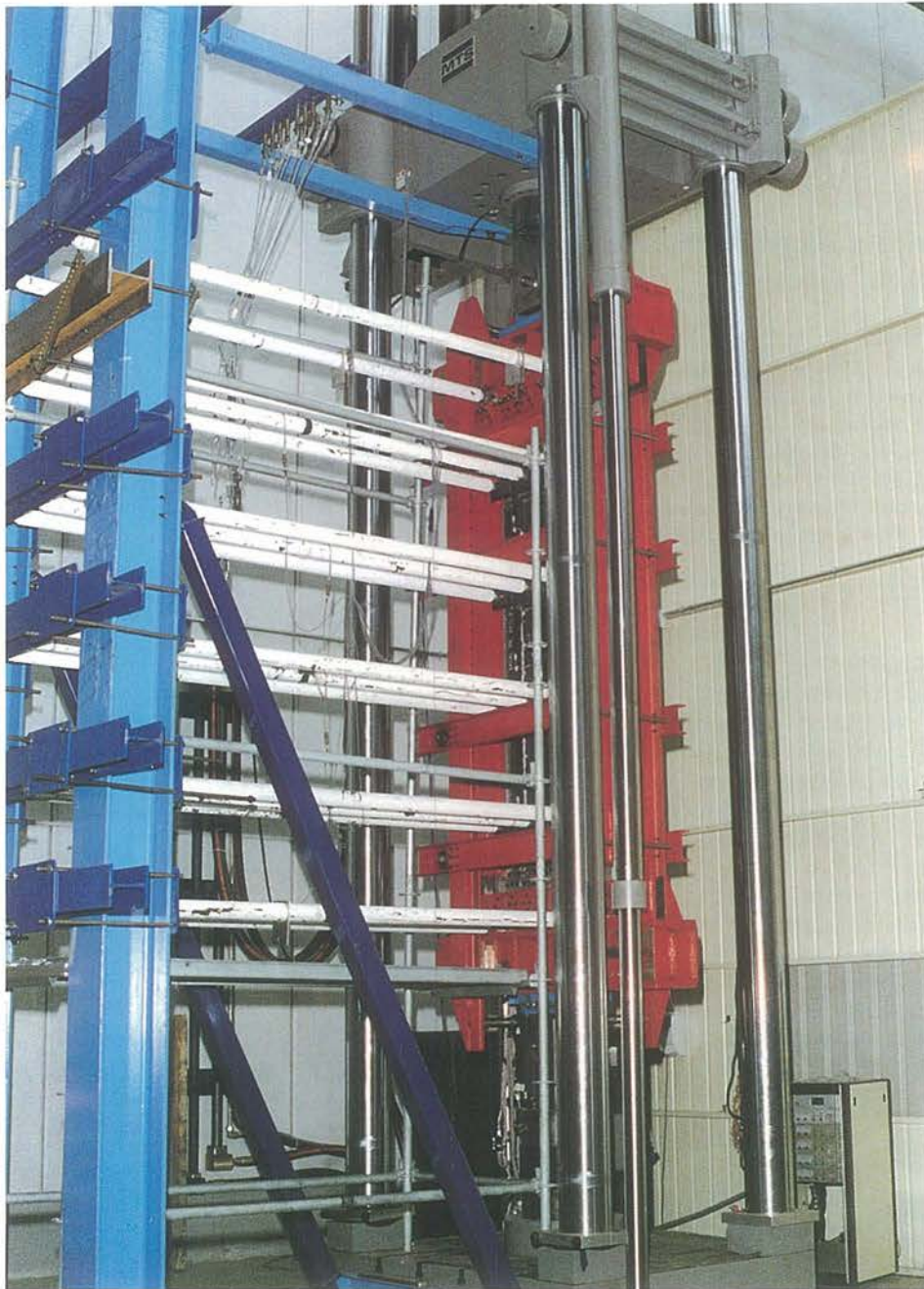
La foto muestra un panel de Fibra de Carbono (subcomponente) dentro de un marco (útil de ensayo) diseñado para introducir carga por compresión en la máquina universal de ensayo de 500 T.m. El panel está estabilizado para impedir deformaciones por pandeo (barras blancas) y se encuentra instrumentado con numerosos extensímetros que nos permiten conocer el estado de esfuerzos en distintos puntos para cada estado de carga.
