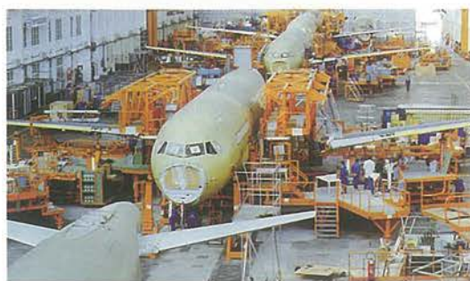
Línea de ensamble final del A-320.
