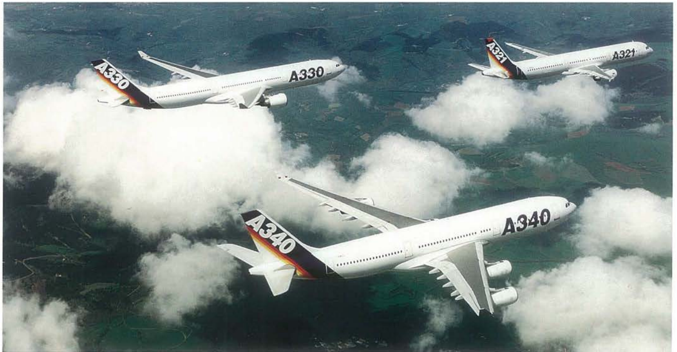
El A340 en su más reciente versión puede llevar hasta 300 pasajeros, con un alcance máximo de 12.000 km.
