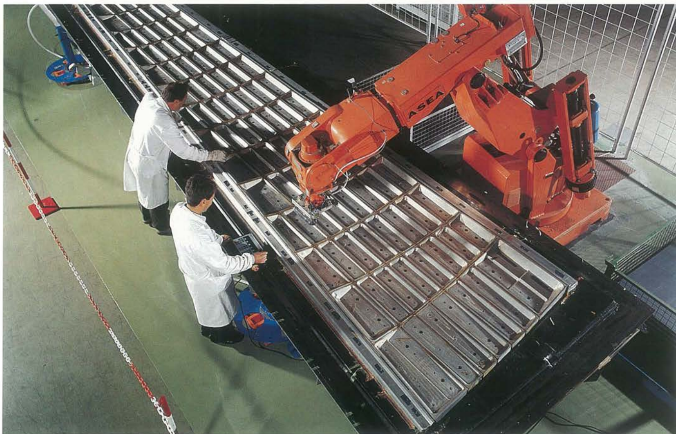
Desmoldeo del revestimiento del estabilizador horizontal del A330/340.
