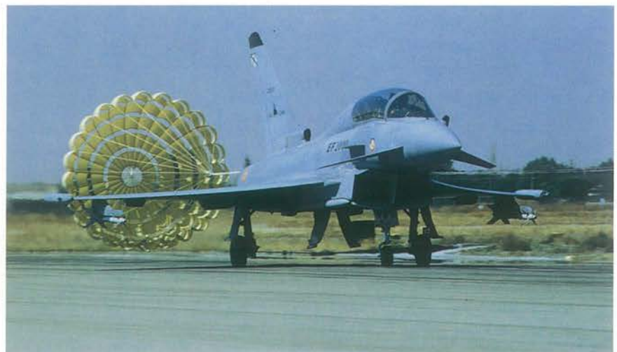
Además del gancho de frenado para casos de emergencia, el avión utiliza el paracaídas de frenado como procedimiento normal, en función del requisito impuesto de aterrizar en 700 mts.
