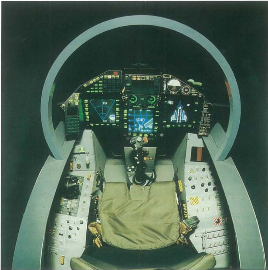
La cabina es uno de los elementos más avanzados de este avión. El "Mando por voz" (DVI) contribuye a simplificar la carga de trabajo del piloto en cabina sin mover sus manos de los controles.
