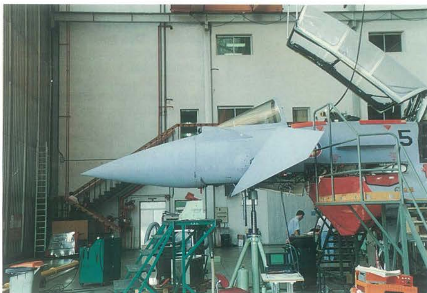
El prototipo DA-6, se ha montado en la factoría de CASA (Getafe) y es el primer doble mando que pone en vuelo el programa.
