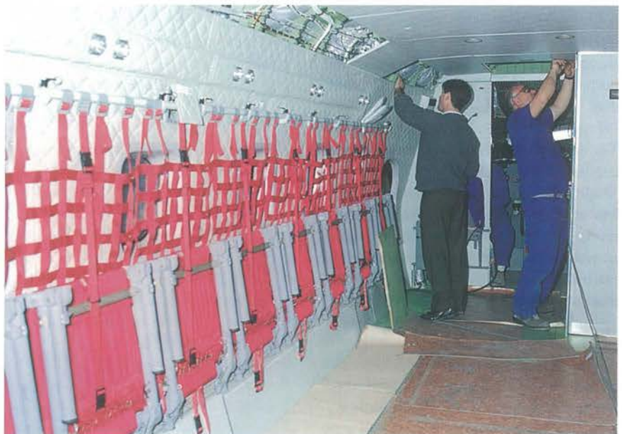
Vista del interior de la cabina de pasajeros en la que se aprecia el nuevo acondicionamiento y los asientos destinados a paracaidistas.
