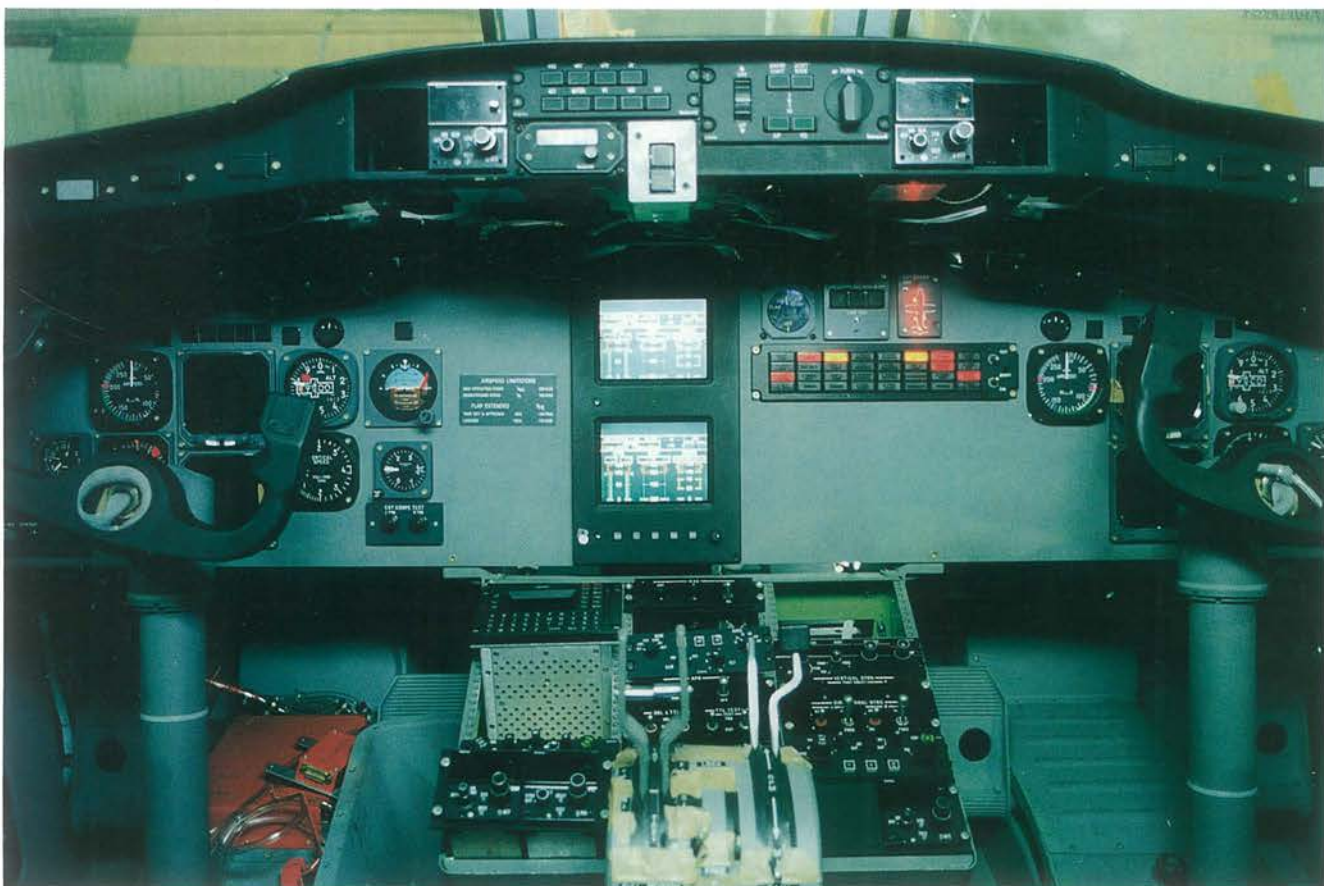
Nuevo tablero de instrumentos con la pantalla digital para las indicaciones de motores integradas.
