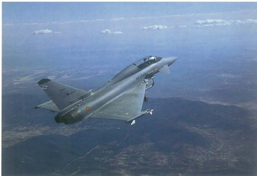
El DA-6 se une al programa de ensayos en vuelo teniendo asignados los ensayos de comunicaciones, control ambiental, lanzamiento de bombas guiadas y pruebas de cañón.
