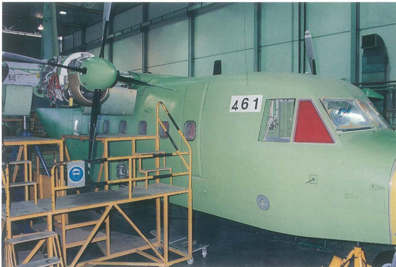
Vista general de la nueva Serie 400 donde puede apreciarse la nueva motorización y las nuevas ventanillas de la cabina de pasajeros.
