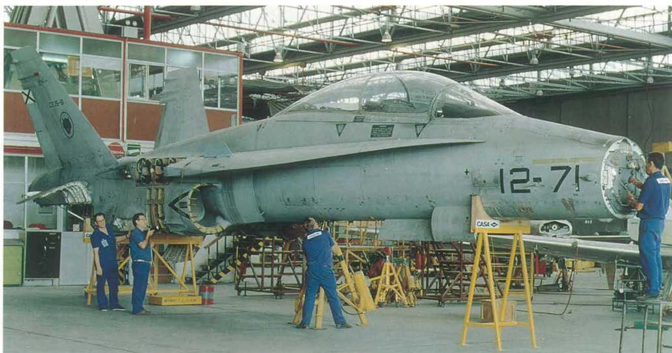
F-18 en las instalaciones del CMA de Getafe. La evaluación de daños ha sido realizada y el diseño de la reparación está finalizado.
