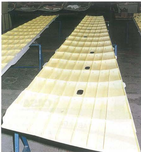
Primer revestimiento "0" defectos.
