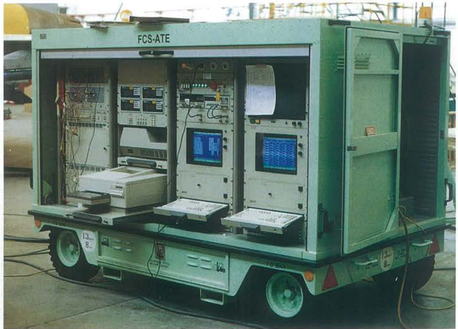
Equipo de ensayos automático de mandos de vuelo ATE.
