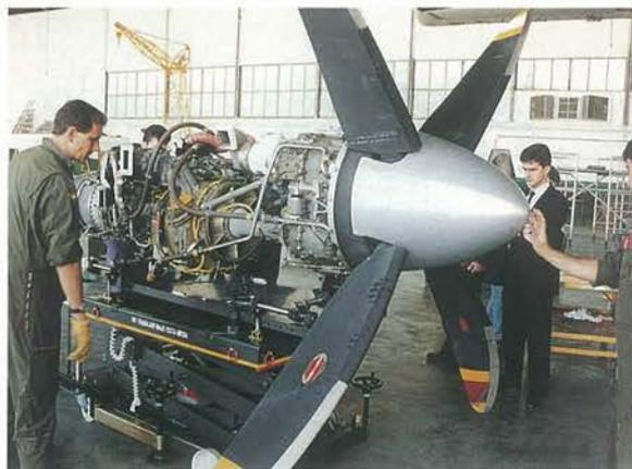
unidad de potencia sobre la misma. Todo ello permite realizar operaciones de mantenimiento como un cambio de la junta de la PGB, con una reducción de tiempo hasta ahora insospechada y que puede llegar hasta un 80%.
