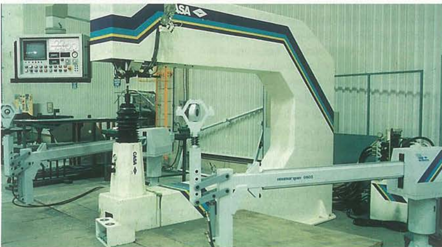
Sistema manipulador para remachadora automática Neumarquín N-2200
