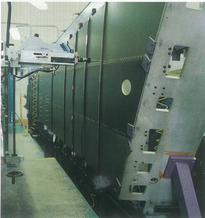
Dispositivo para taladrar revestimientos. Estabilizador horizontal MD-11
