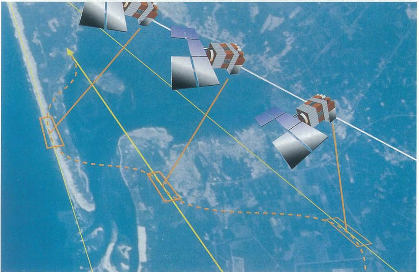
Contrariamente al Spot, que se mantiene en posición geocéntrica, Helios presenta la originalidad de poder encadenar las observaciones por medio del basculamiento de su estructura. (Foto de Air Actualités)
