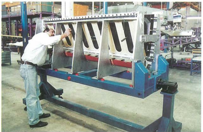
Primer borde de ataque del A-340 con tecnología de conformado superplástico, soldadura por difusión y fibra de carbono.
