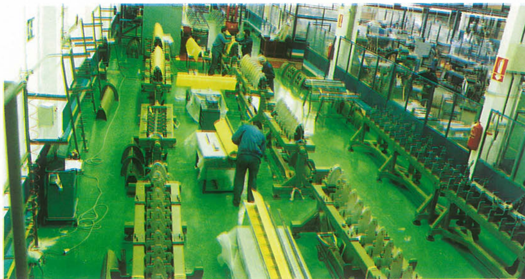
Montaje de subconjuntos bordes de ataque Saab-2000.
