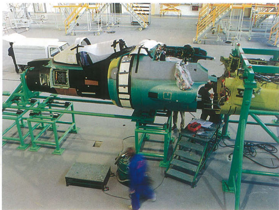
Línea de montaje del Harrier AV8B - Plus en Factoría de San Pablo.
