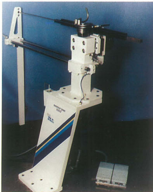
Máquina para fabricar serpentines de titanio para el Airbus.
