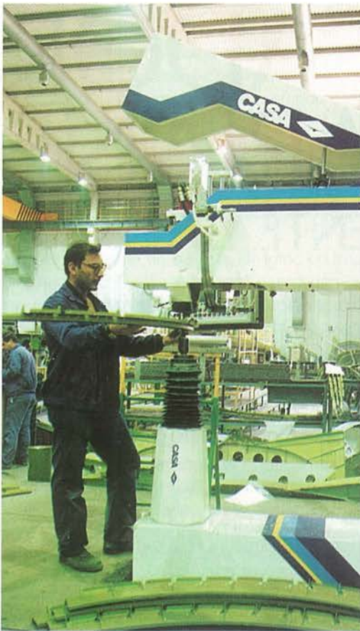
Máquina de remachar, diseñada y fabricada por Factoría de Tablada, realizando trabajos de subconjuntos del CN-235 en UTT
