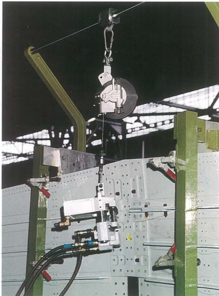
La máquina de taladrado Splice situada en la zona de unión de los revestimientos con la costilla.
