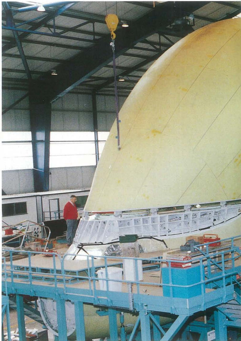
Momento del ensamblaje de la compuerta de carga superior.
