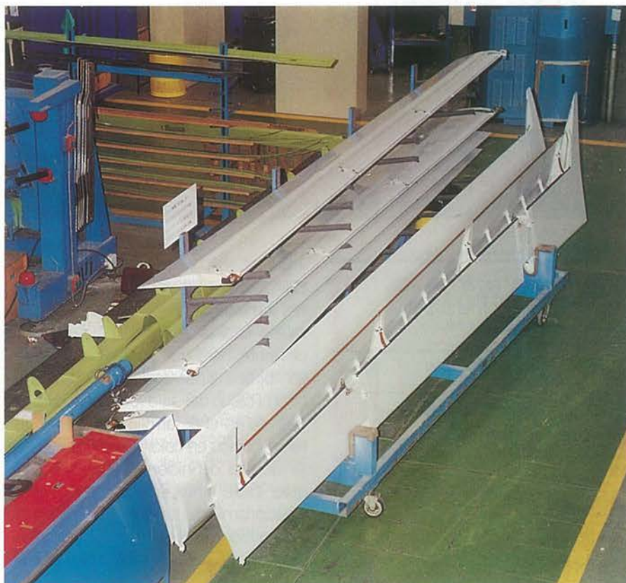
El conjunto del flap principal y flap posterior forma el flap exterior..
