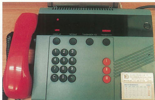
Centralita de busca-persona. Oficina Técnica de Mantenimiento
