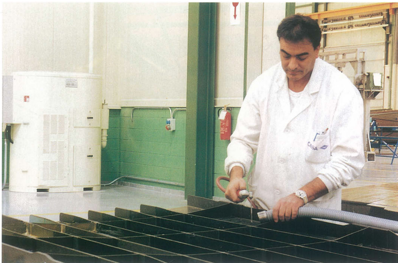
Aspiración en operación de taladrado en paños de Airbus.
