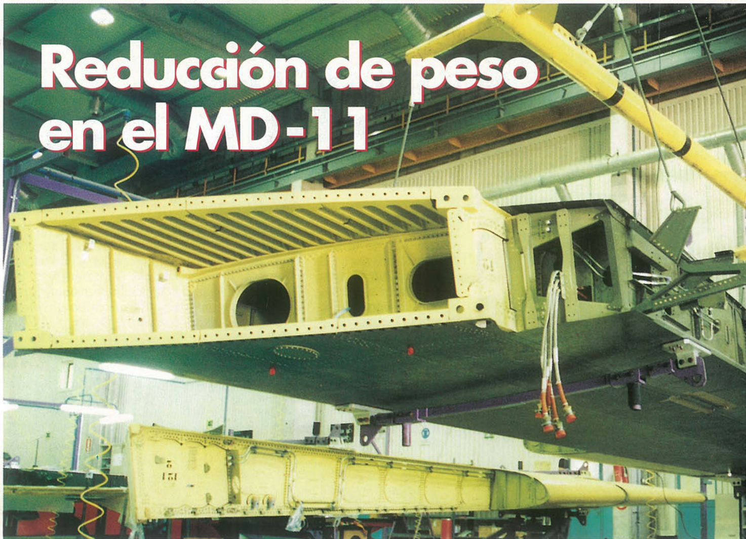
Estabilizador horizontal del MD-11, en el momento de la pesada.
