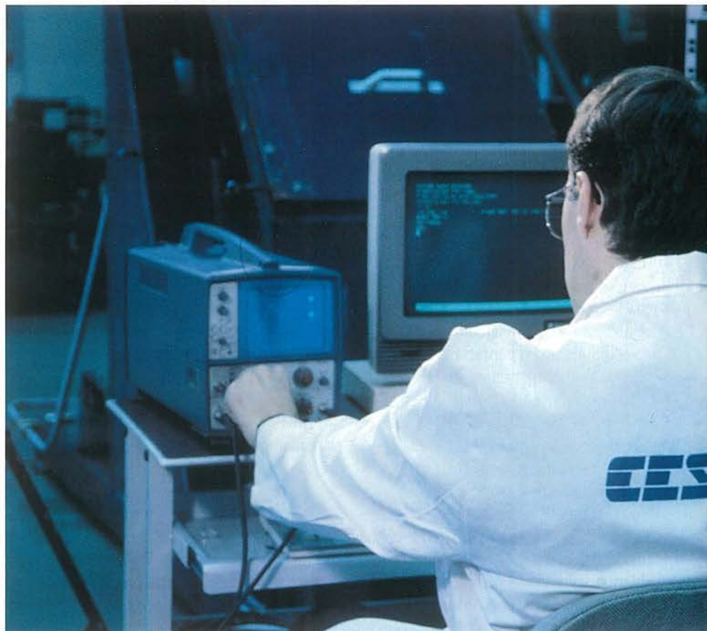
▲ Banco de ensayo hidráulico utilizado en las pruebas de duración y fatiga de equipos fabricados por CESA.
