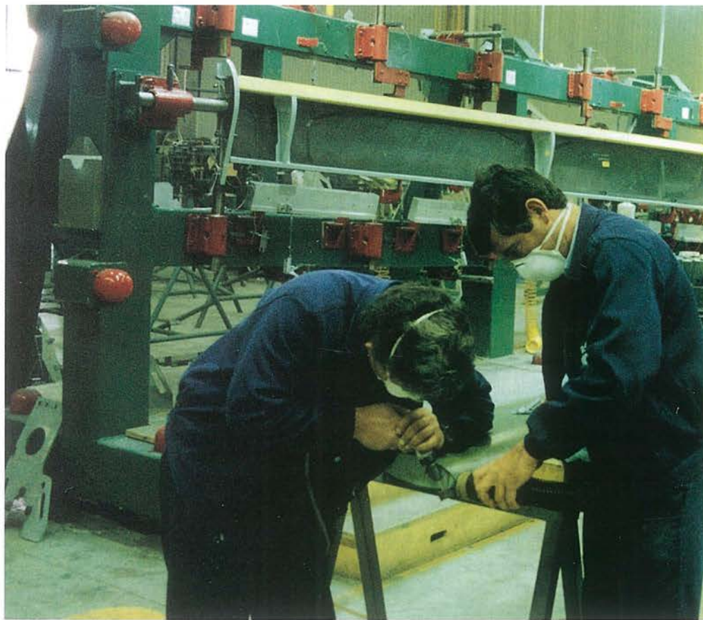
▲ Operarios trabajando fuera de grada en un alerón del programa Saab-2000.
