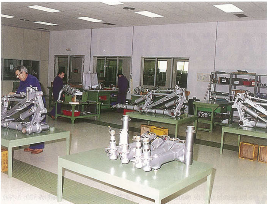
▲ Operaciones finales en el tren de aterrizaje del CN-235
