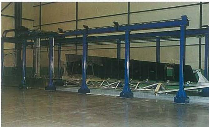
▲ Equipo automático de inspección ultrasónica.
