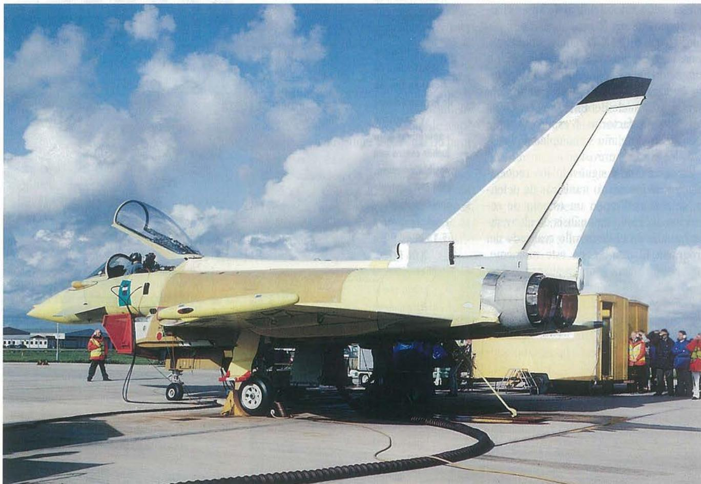
▲ Segundo prototipo (DA2) realizando el rodaje de motores a máxima potencia con postcombustión en British Aerospace.
