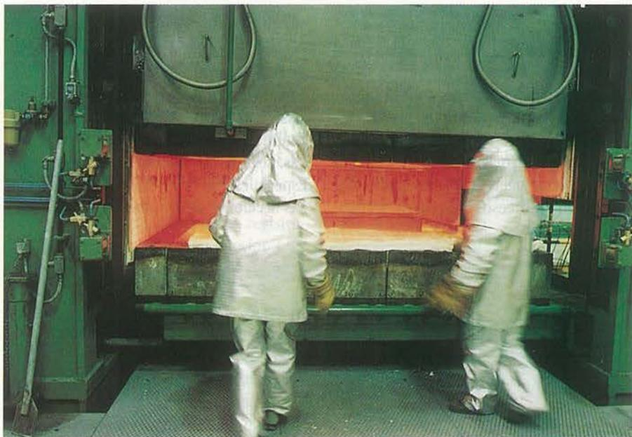
◀ Sistema antiguo de extracción de piezas de la prensa de conformado superplástico.
