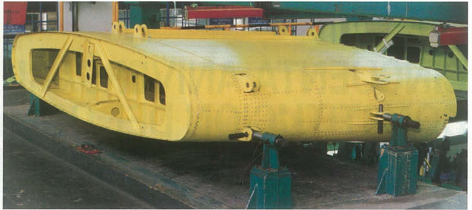
Conjunto colón en la grada de montaje.
