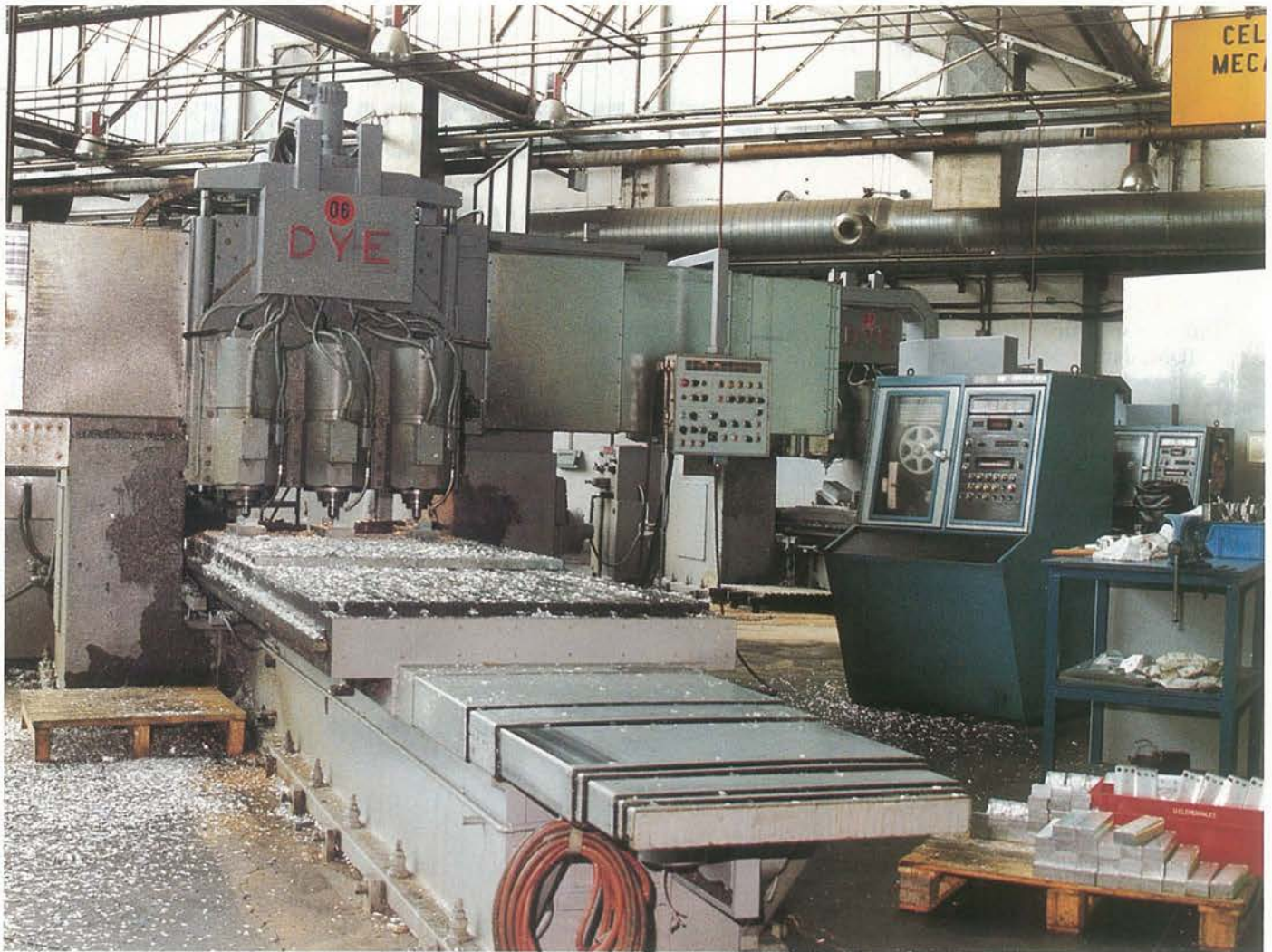
Máquina de la célula A -en activo- con el nuevo sistema de paleización incorporado.
