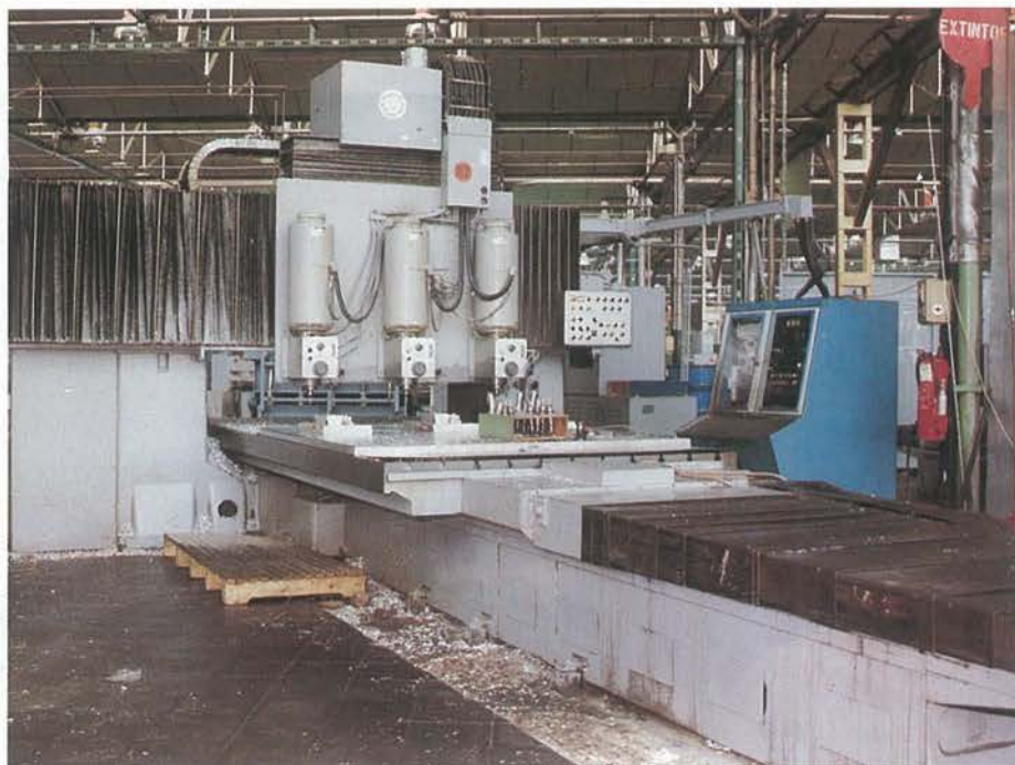
Fresadora de tres cabezales trabajando con sistema paletizado.
