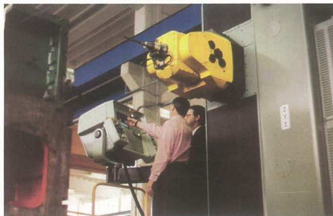
Puesto de control y cabezal de la máquina JOBS
