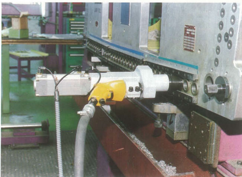
Dispositivo de redoblado ( Neumarquin-2600 )
