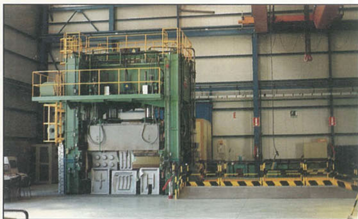
Prensa para el conformado superplástico y soldadura por difusión.
