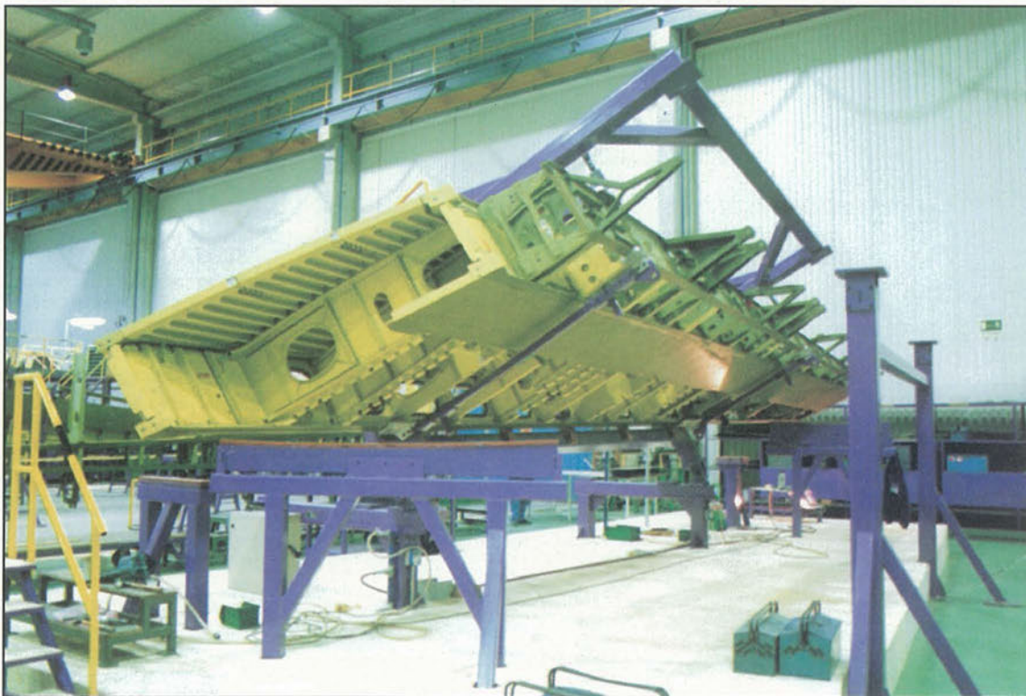
Detalle de la grada abatible diseñada para remachar el estabilizador horizontal.
