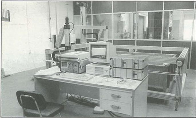
*Instalación de inspección ultrasónica automática. (Foto n.º 2)*
