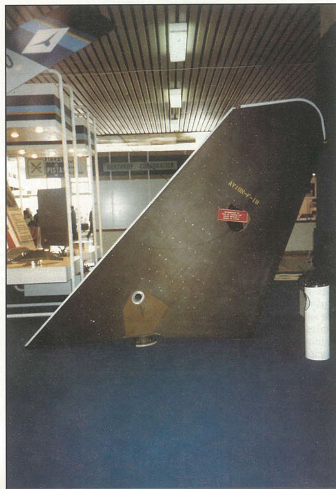
Pieza en fibra de carbono fabricada en CASA para el F-18.
