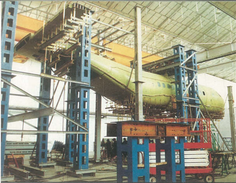
Ensayos estáticos en el TMD de Getafe.
