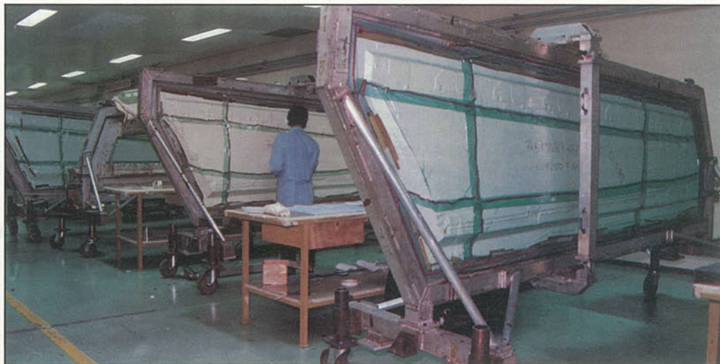
Batería de útiles de autoclaves con flaps de borde de ataque interiores del F-18, preparados para ser curados.
