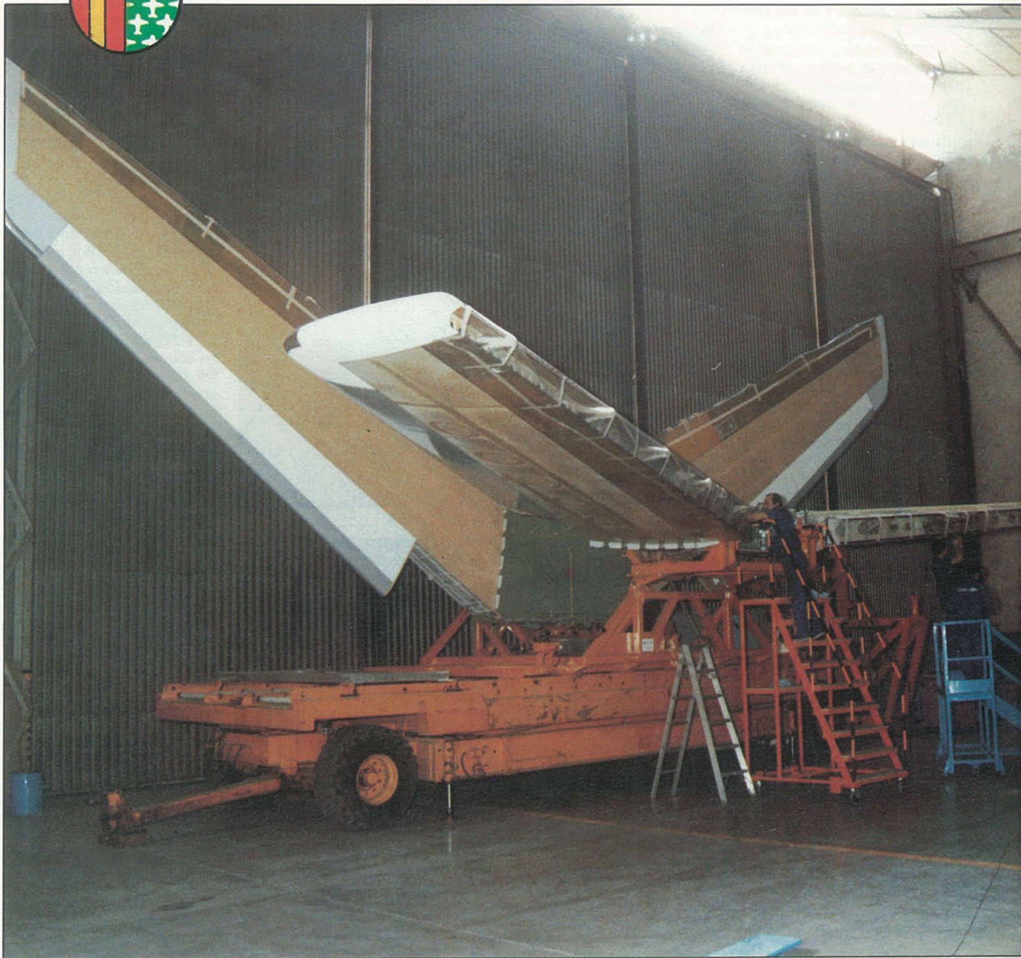
Estabilizador del Airbus A-320 fabricado en fibra de carbono preparado para su envío a Toulouse.
