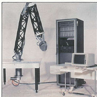
Maqueta funcional del prototipo manipulador.
