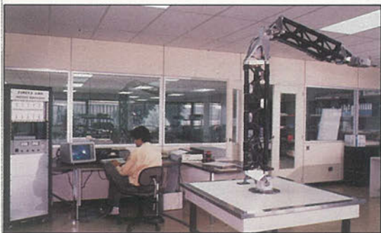
Proyecto funcional de manipulador fabricado en fibra de carbono y aluminio (laboratorio de robótica).
