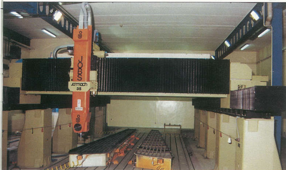
Máquina de recantado por control numérico.
