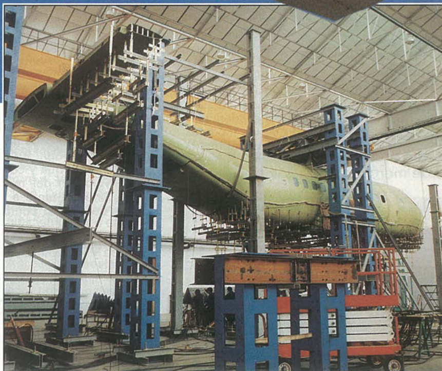
El fuselaje del CN-235, suspendido en su estructura soporte, pasando uno de los ensayos estáticos de certificación en el TMD.
