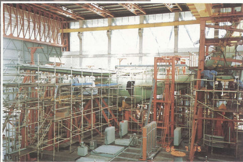
Vista general del Ensayo de Fatiga del avión CN-235.
