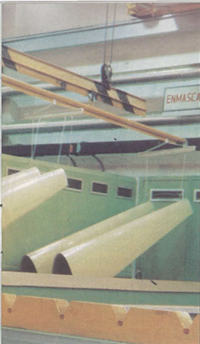
Proceso de enmascarado en los bordes de ataque del CN-235
