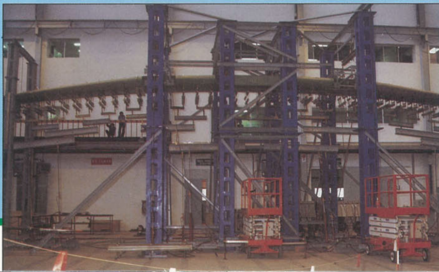
Ensayo estático del ala del CN-235.
