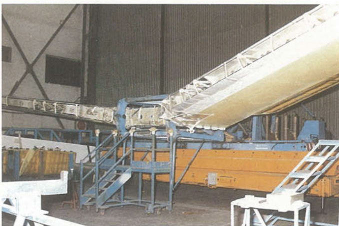
Fase final del Trim-Trank acabado y dispuesto a su traslado.
