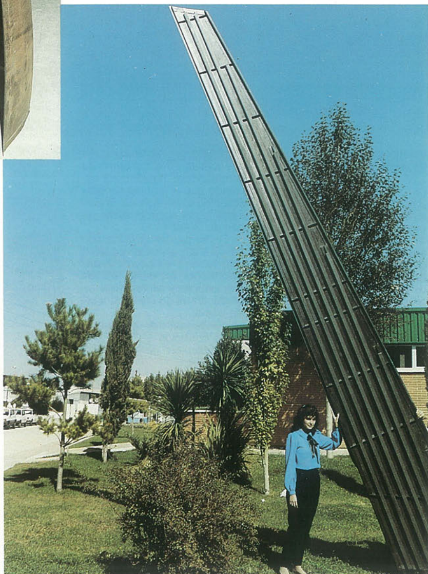
Pieza en fibra de carbono estabilizador Airbus 320
