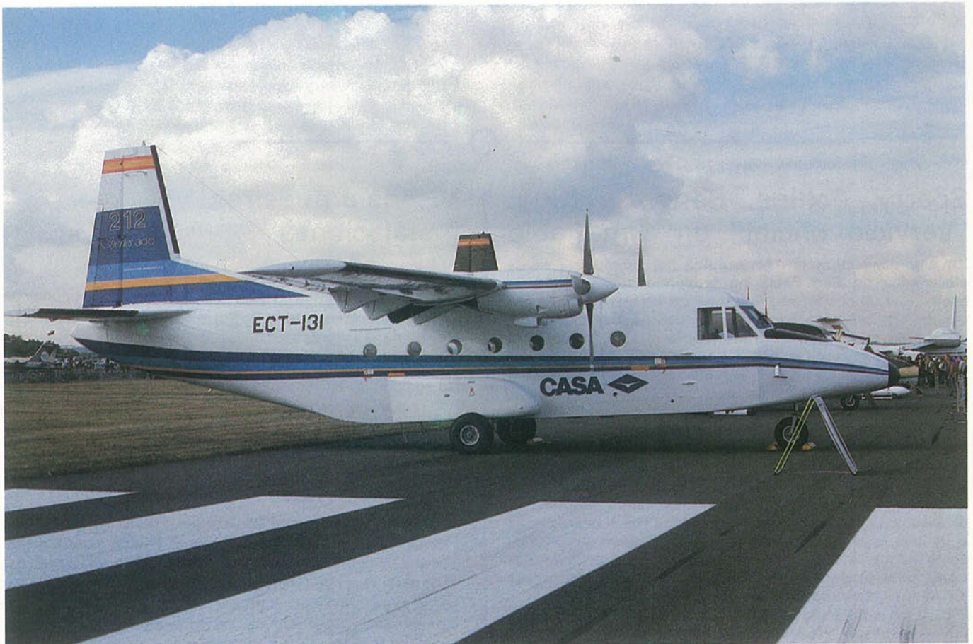
C-212, Aviocar Serie 300. Destaca su morro alargado y el nuevo fuselaje posterior.
