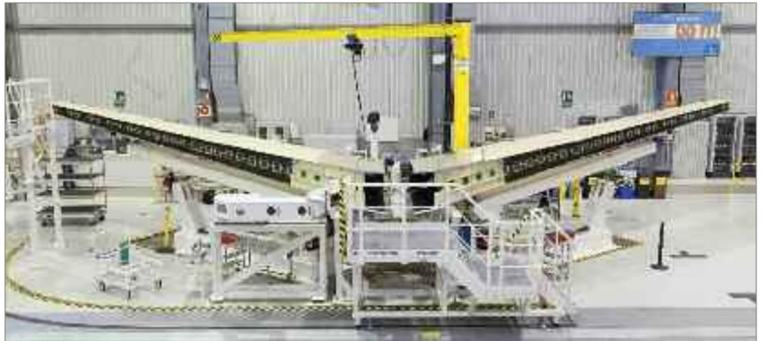
Primer estabilizador horizontal sobre el que se seguirá trabajando, equipándolo y uniéndolo físicamente a los timones de altura con el fin de completar la pieza.
