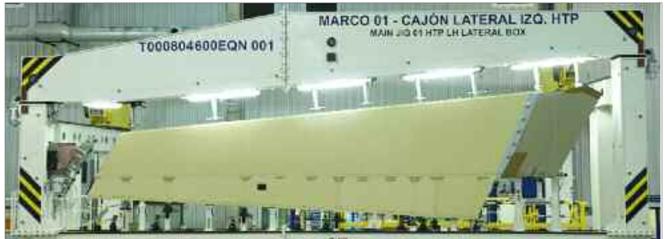
Primer Cajón Lateral del estabilizador horizontal del A350XWB listo para su envío a la planta de Airbus en Getafe
