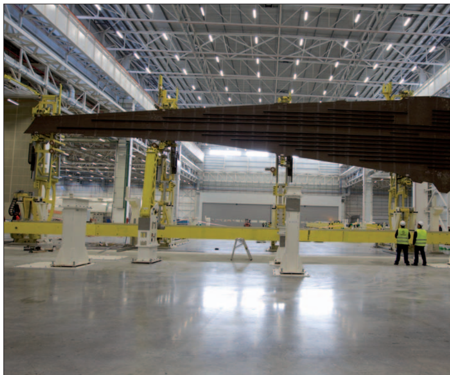
El revestimiento inferior del ala, una de las piezas más grandes y complejas en fibra de carbono jamás construidas
