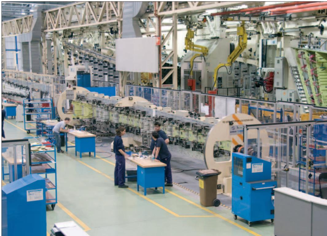
Vista general de la sección de montaje del estabilizador horizontal del A380, en la planta de Airbus.
