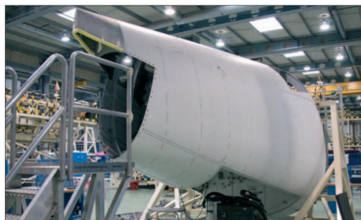
Fuselaje de la cola del A380. Esta parte del avión se monta en la sección 19.1.
