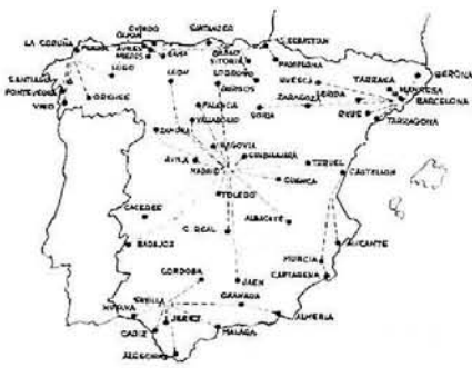
Las centrales terminales ARB-111 enlazan con las centrales regionales
