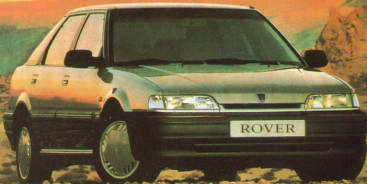
**EL Nuevo Rover Serie 200 es todo un cambio. Es diseño absoluto. Es alta tecnología. En su motor de hasta 1.590 c.c. y 16 válvulas. Con inyección electrónica. Construido totalmente en aluminio.**
