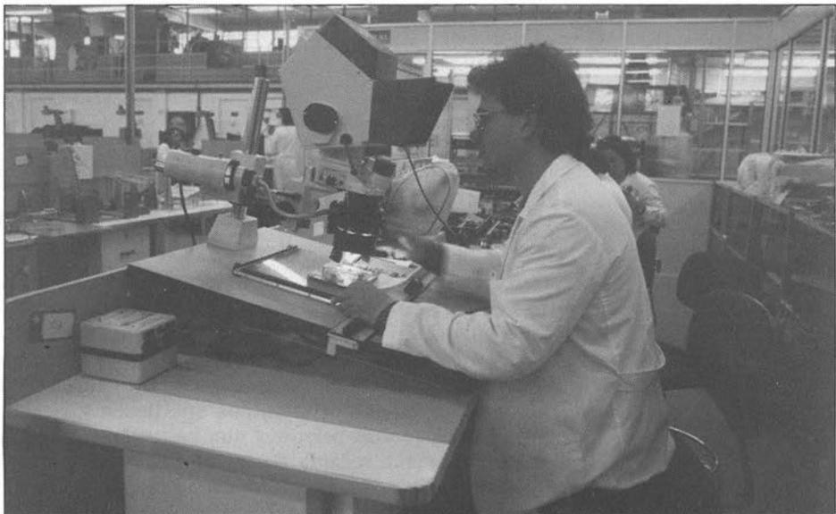
En la fotografía superior un técnico revisa, uno a uno, todos los puntos de soldaduras. Es una prueba más del control de calidad durante el montaje.
