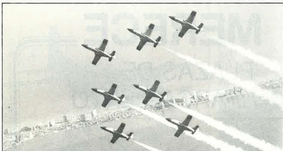
El C-101 es un avión entrenador completo. Su capacidad interna de combustible y el bajo consumo específico del motor le hacen idóneo para las misiones de apoyo táctico y ataque al suelo.
