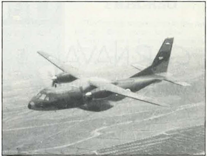
El CN-235 militar. Permite transportar hasta 54 soldados, vehículos ligeros, etc... Es óptimo para el transporte regional.
