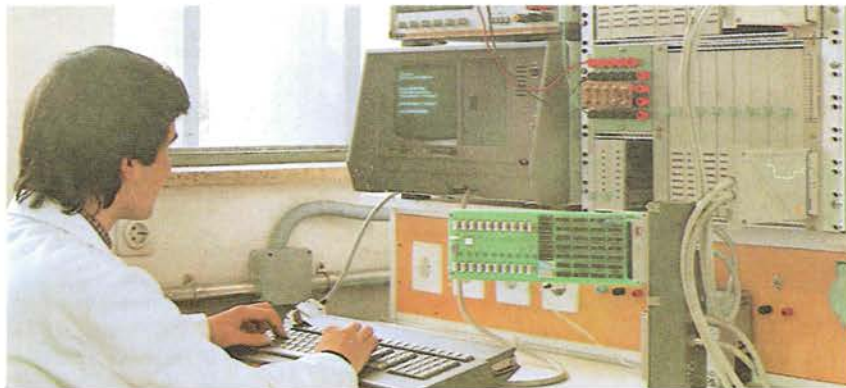
Izquierda: Equipo con ordenador para pruebas funcionales de módulos electrónicos. Derecha: Vista parcial de la Sección de prefabricación.
