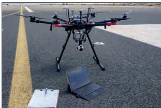
dron realiza esta inspección en menos de 3 minutos. La inspección se realiza en tiempo real, y genera un informe con las imágenes para referencia futura.
