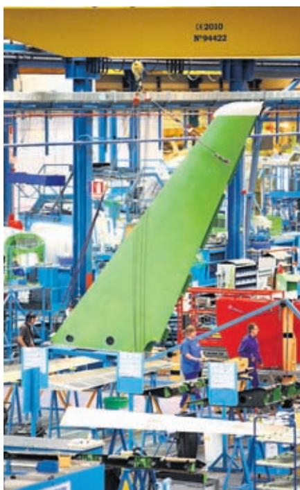
modelo: Aernnova en el diseño y fabricación del estabilizador horizontal, el timón de profundidad y el mamparo de presión de la bahía del tren de aterrizaje principal (MLGB Rear Bulkhead), así como en la fabricación del Rudder (timón de cola) y en el diseño del borde de salida del ala. Por su parte, Alestis trabaja en el diseño y fabricación de la Belly fairing (el carenado ventral) y la sección 19.1 (el cono de cola).
