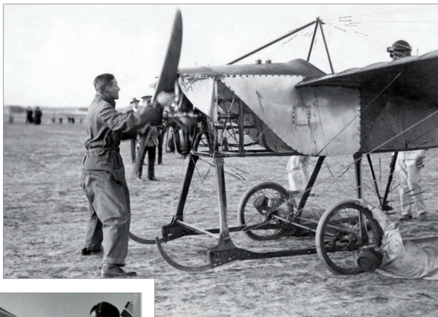
Cebando los cilindros para el arranque de un Bristol Prier pilotado por el inglés Busteed. Aeródromo de Cuatro Vientos en 1913. (Imagen de Prensa gráfica de la época).
