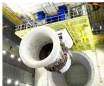
Reactor Rolls-Royce trent XWB en uno de los bancos de ensayo en la factoría de Derby.
