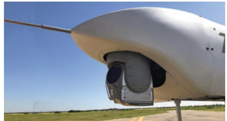
Se trata de un sistema giroestabilizado que incorpora la capacidad de designación pulsada láser, además de las capacidades de ISR basada en sensores electroópticos e infrarrojos en banda media para localizar e identificar objetivos a larga distancia, tanto en operaciones diurnas como nocturnas. Actualmente no existe a nivel europeo ningún otro operador o fabricante de UAS que haya logrado hacer una integración de un designador láser conforme a la
