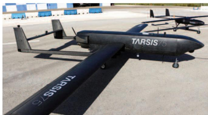
Por su parte, el TARSIS 75 es otra de las plataformas aéreas no tripuladas de AERTEC que permite también múltiples configuraciones, y sus aplicaciones se concentran en mayor medida en el ámbito de la defensa. Cuenta con un peso máximo al despegue de 75 kg., una carga máxima de 12 kg. y una autonomía de 12 horas de vuelo, y puede alcanzar una altitud máxima de 5 000 metros sobre el nivel del mar y un alcance de hasta 160 km de radio de co-
