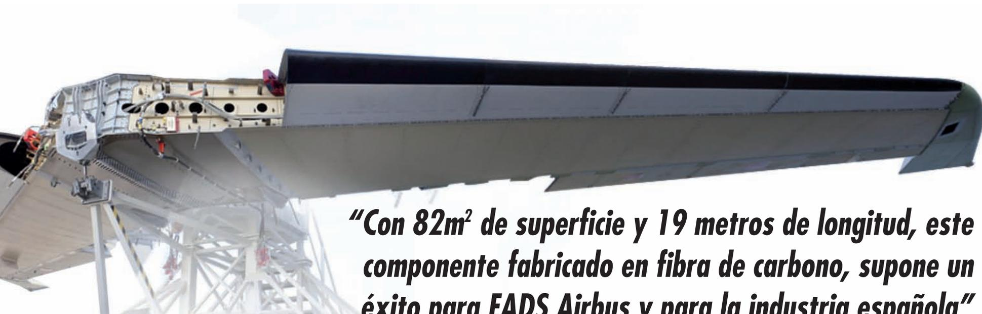
***"Con 82m<sup>2</sup> de superficie y 19 metros de longitud, este componente fabricado en fibra de carbono, supone un éxito para EADS Airbus y para la industria española"***
