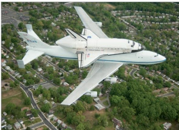
Imagen del traslado del Discovery a bordo del SCA.
